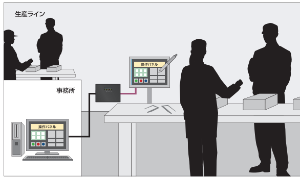
事務所にあるホストPCを、生産ライン現場から遠隔操作。
