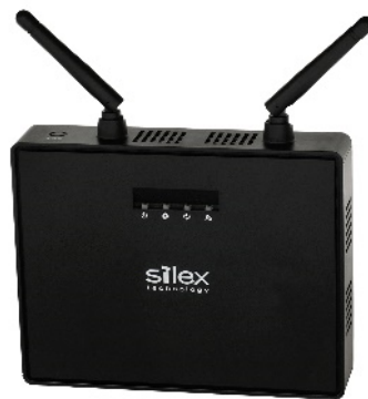
インタラクティブ画像伝送対応無線 LAN アクセスポイント 『SX-ND-4350WAN Plus』
