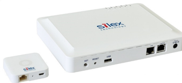
高速 DFS 技術搭載 11ac 対応アクセスポイント AP-511AC
