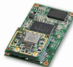
『SX-IMAPP-SDK』に搭載されている インテリジェントタイプ 無線 LAN モジュール 『SX-580-2700DM』
